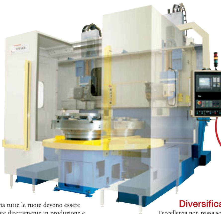
I torni della Serie P nascono quale naturale completamento della gamma dei torni di medio-piccola capacità tornibile. La foto mostra il modello P6-T4
